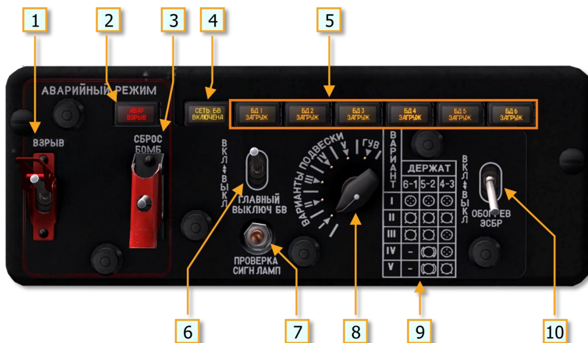
Рис. 8.7. Пульт бомбардировочного вооружения летчика-штурмана
