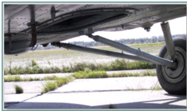
Рис. 5.62. Антенна типа НИПВ
