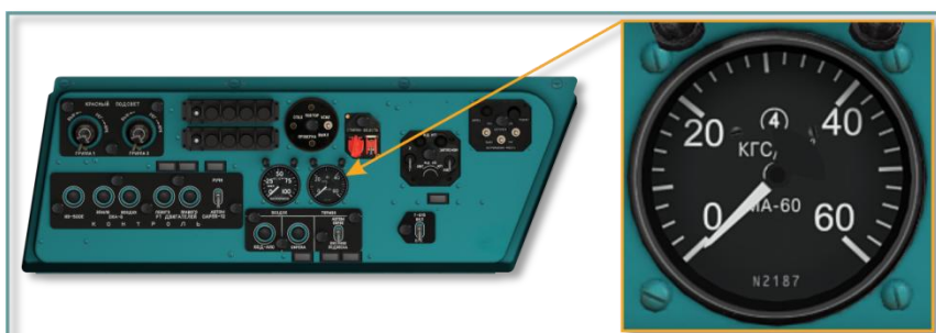
Рис. 5.35. Манометр МА-6К
