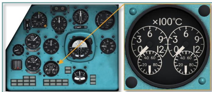
Рис. 5.24. Указатель температуры выходящих газов двигателей 2УТ-6К
