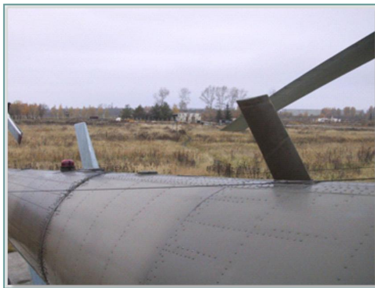
Рис. 5.68. Ненаправленная антенна АШС-УД
