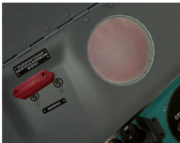
Рис. 8.4. Расположение предохранительных выключателей вооружения вместе с плафоном, сигнализирующим об их включении (красного цвета).
