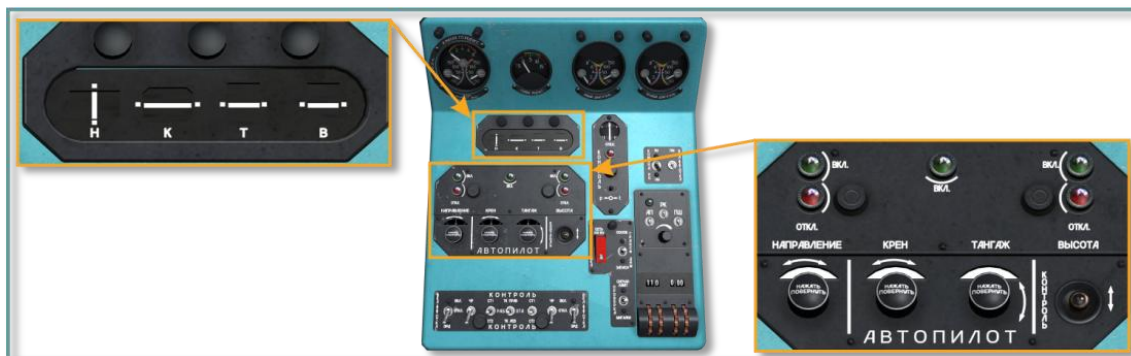
Рис. 5.56. Расположение органов управления автопилотом
