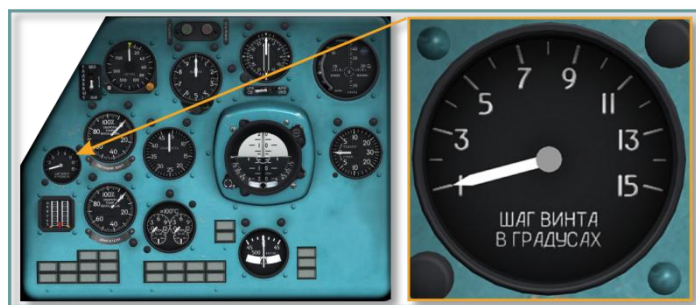
Рис. 5.31. Указатель шага винта УП-21-15
