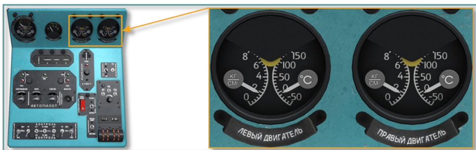
Рис. 5.22. Двухстрелочный моторный индикатор ЭМИ-ЗПИ
