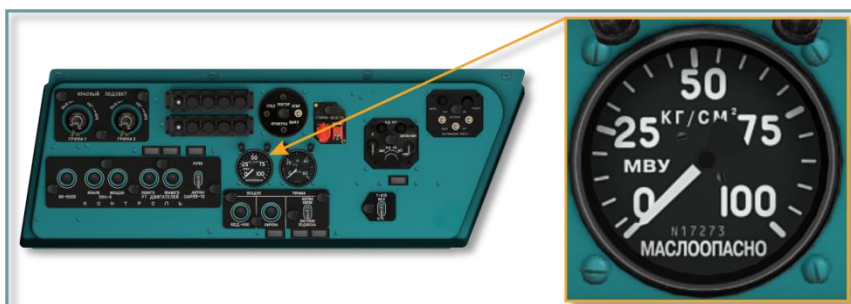
Рис. 5.34. Манометр МВУ-100К
