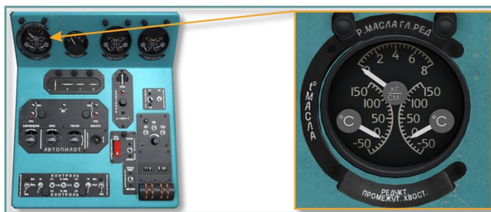
Рис. 5.23. Трехстрелочный моторный индикатор ЭМИ-ЗРВИ
