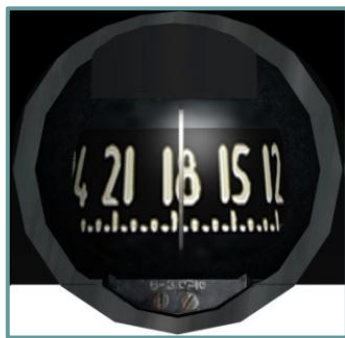
Рис. 5.51. Магнитный авиационный компас КИ-13К
