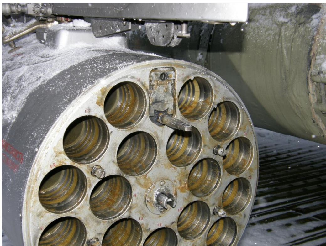
Рис.8.13.Трубы – стволы блока Б8В20-А.
