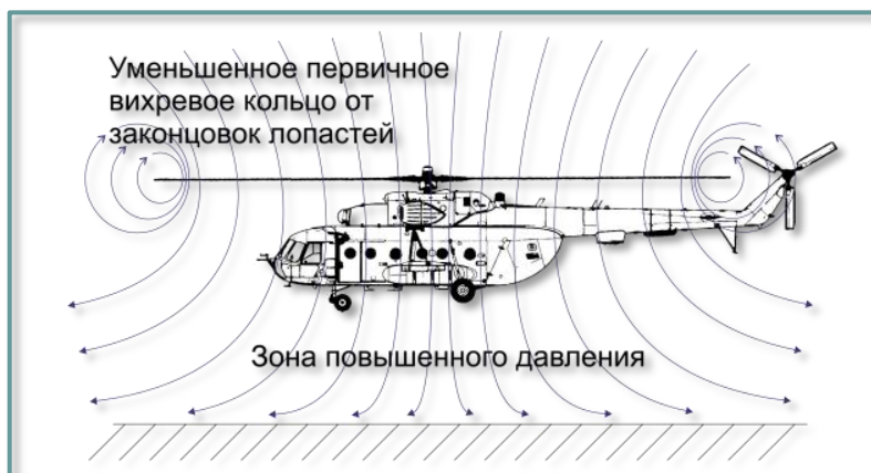
Рис. 3.15. Схема воздушных потоков с учетом эффекта влияния земли
