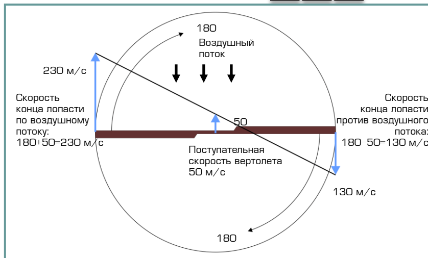
Рис. 3.7. Разница скоростей на концах лопастей несущего винта при поступательном движении вертолета
