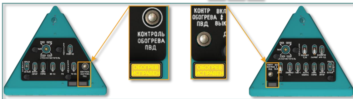
Рис. 5.40. Табло и кнопка контроля обогрева ПВД
