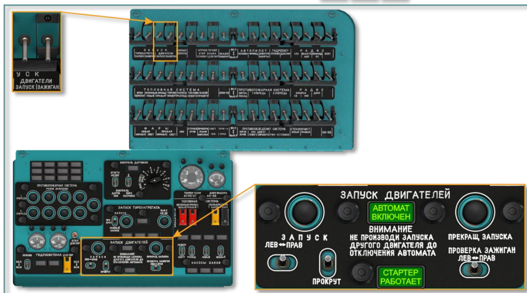
Рис. 4.7. Панель запуска двигателей
