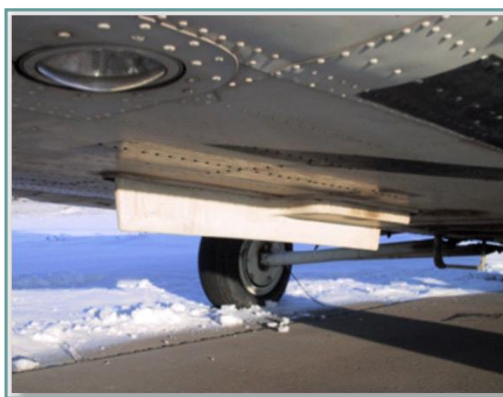
Рис. 5.65. Рамочная и ненаправленная антенны
