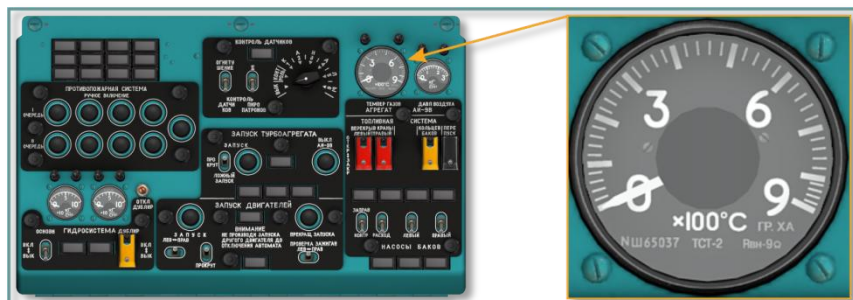
Рис. 5.28. Индикатор температуры ТСТ-2
