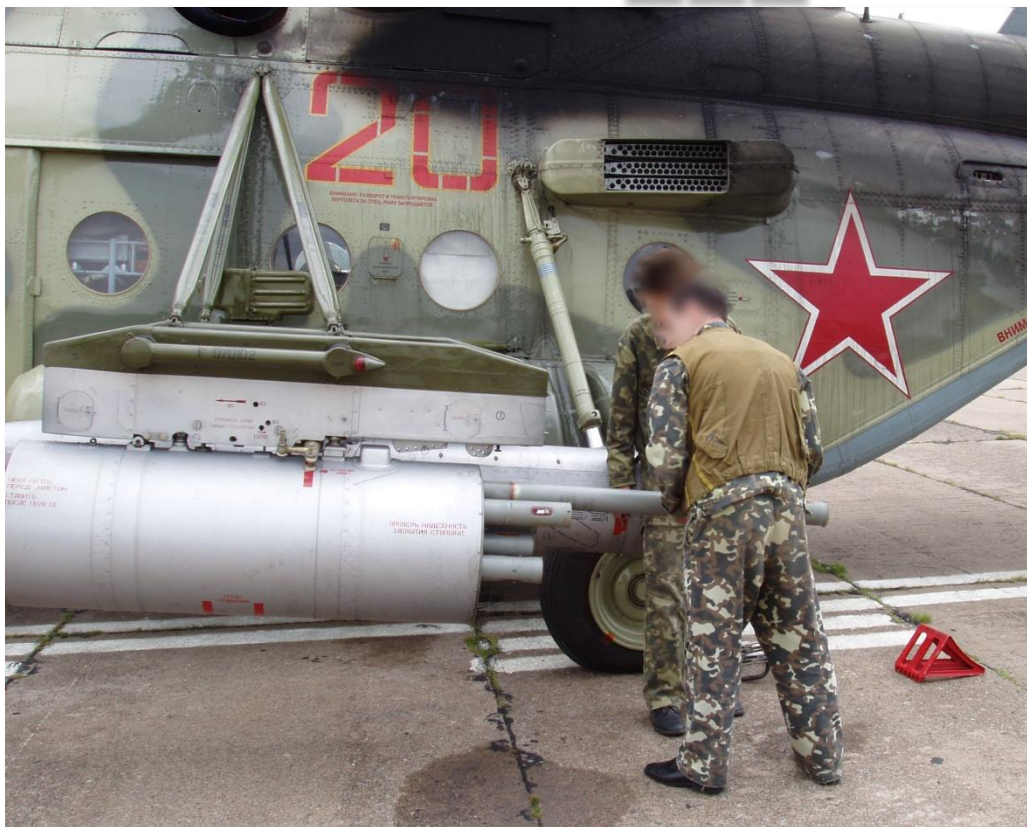
Рис.8.12. Зарядка блоков Б8В20-А на вертолет Ми-8МТВ5.
