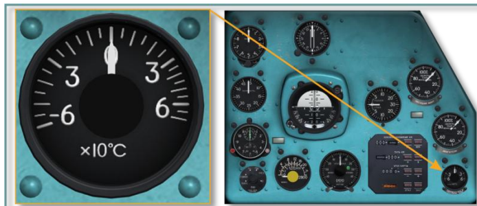
Рис. 5.27. Термометр ТВ-19
