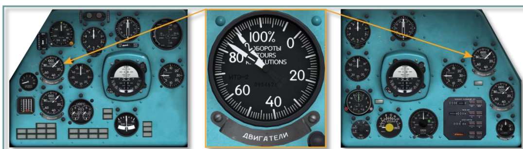
Рис. 5.20. Двухстрелочный тахометр ИТЭ-2Т
