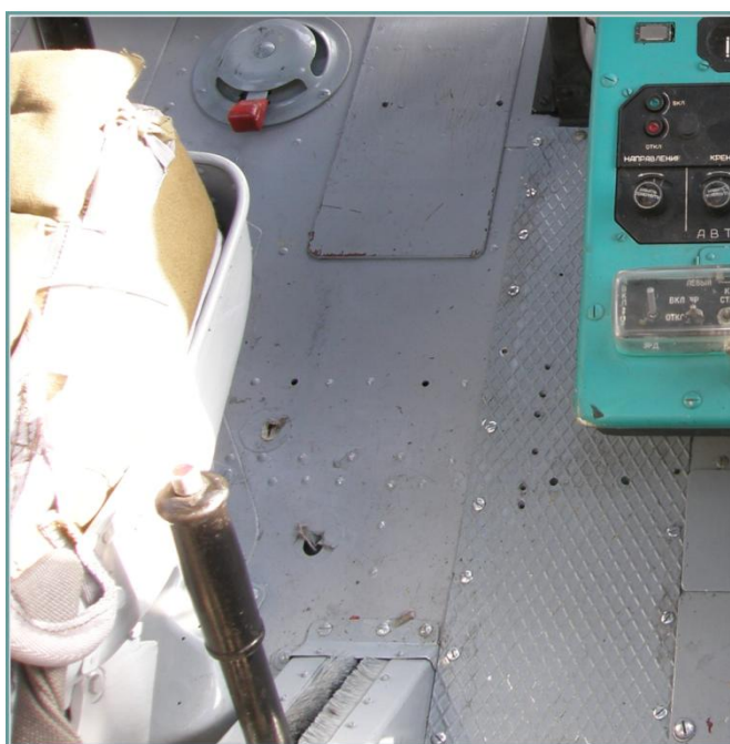
Рис. 4.9. Рычаг системы торможения НВ
