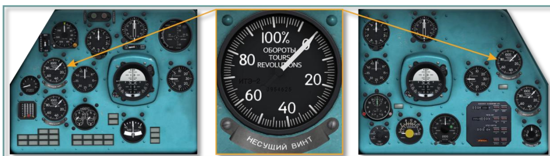
Рис. 5.21. Тахометр ИТЭ-1Т
