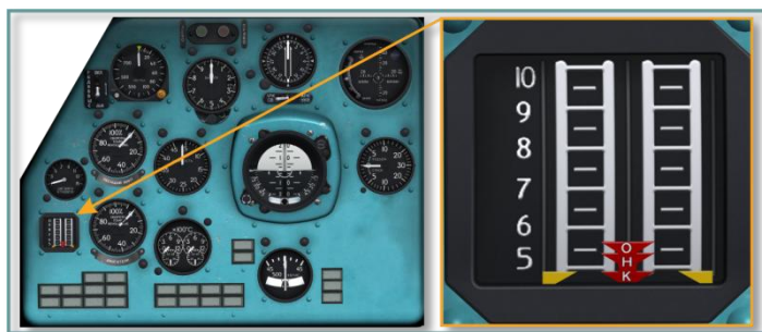
Рис. 5.25. Измеритель режимов работы двигателей ИР-117
