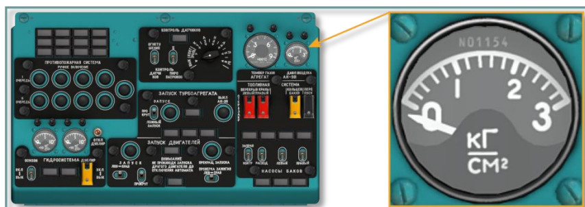
Рис. 5.29. Указатель давления воздуха УИ1-3
