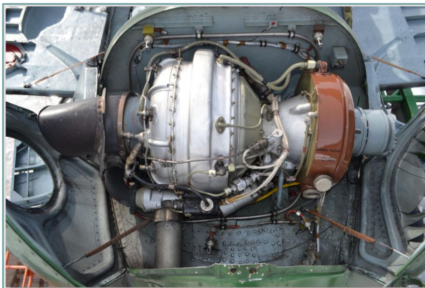
Рис. 4.4. Газотурбинный двигатель АИ-9В
