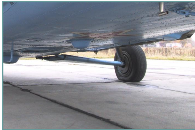
Рис. 5.67. Антенный блок АРК-УД
