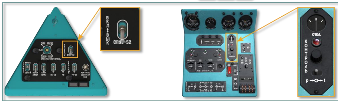
Рис. 5.18. Органы управления и контроля СПУУ-52
