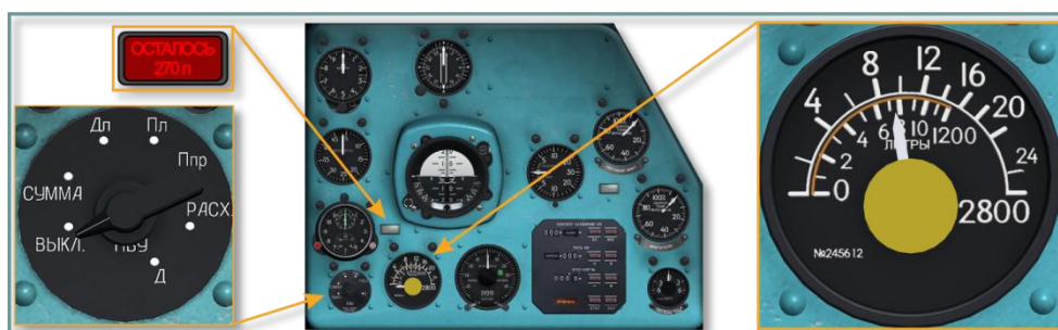
Рис. 5.32. Топливомер СКЭС-2027В
