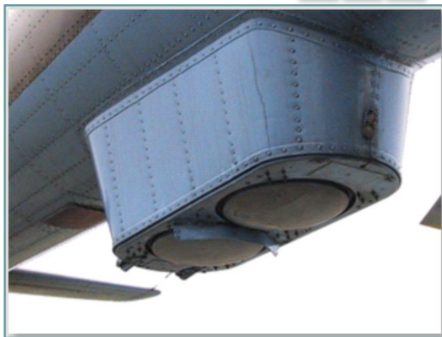
Рис. 5.70. Высокочастотный блок ДИСС-15
