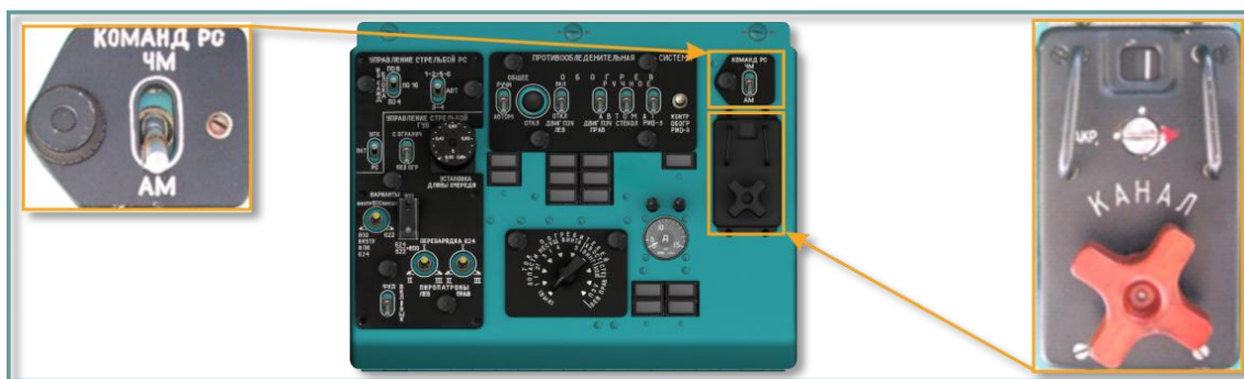
Рис. 5.58. Переключатель «КОМАНД. РС АМ-ЧМ» для выбора вида модуляции несущей частоты звуковых колебаний; запоминающее устройство (ЗУ) с переключателем на 20 каналов
